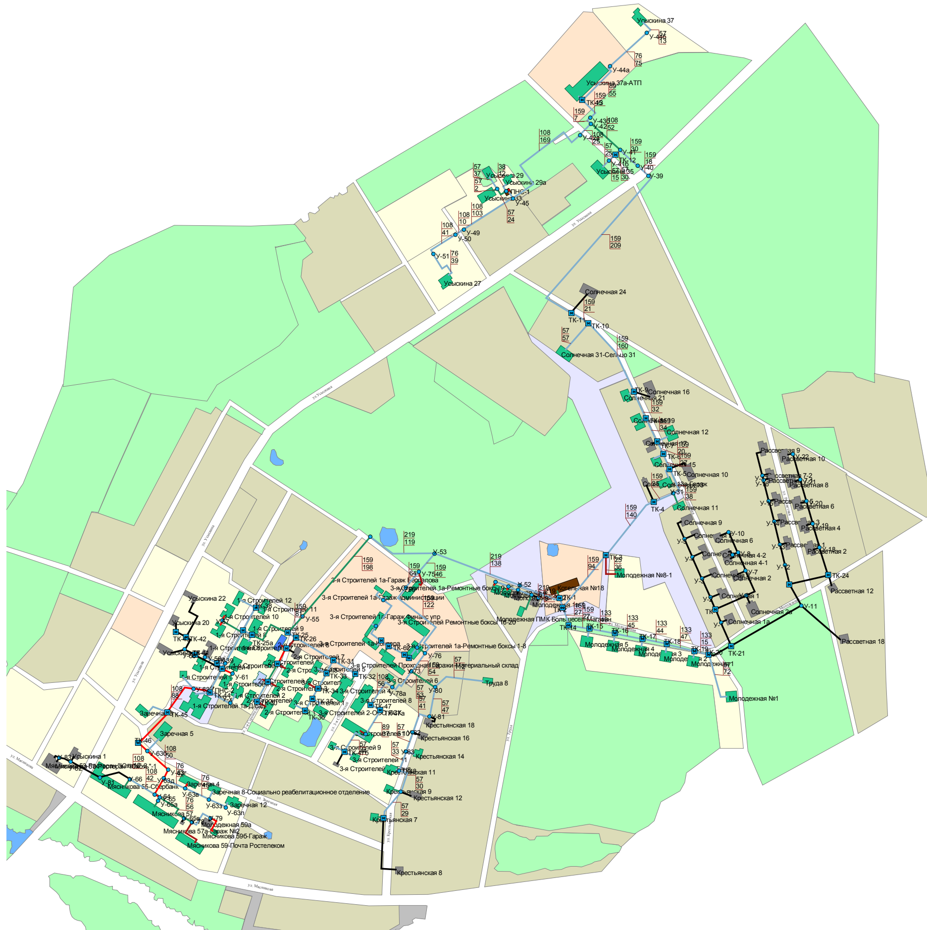
Рис. 6.2.6. Схема тепловых сетей от источника тепловой энергии котельная №18 «Сельцо» с. Большое село в наладочном режиме
