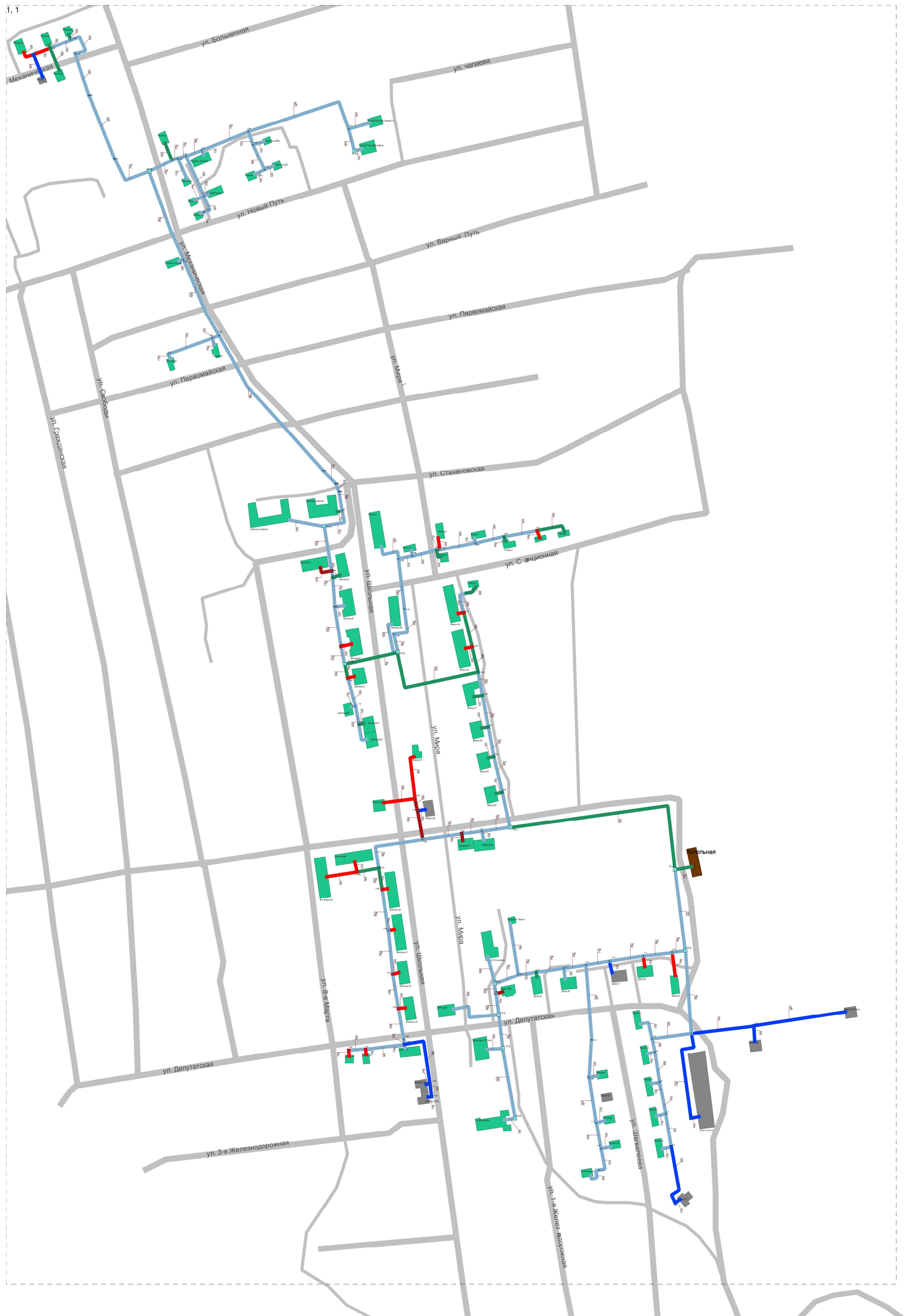
Рис. 1.6. Схема тепловых сетей котельной с. Варегово в наладочном режиме.
