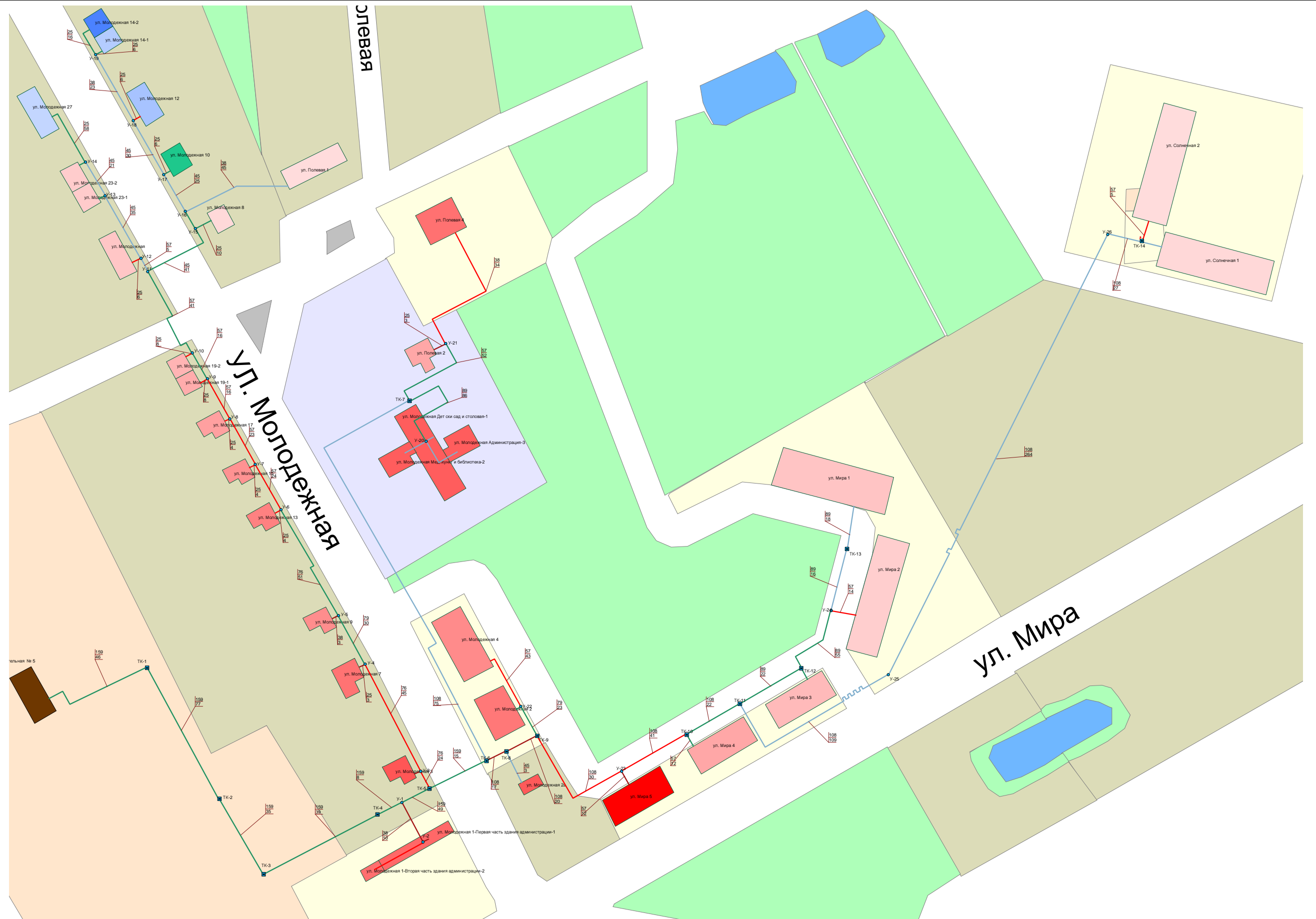
Рис. 4. Котельная д. Борисовское - существующее положение системы теплоснабжения
