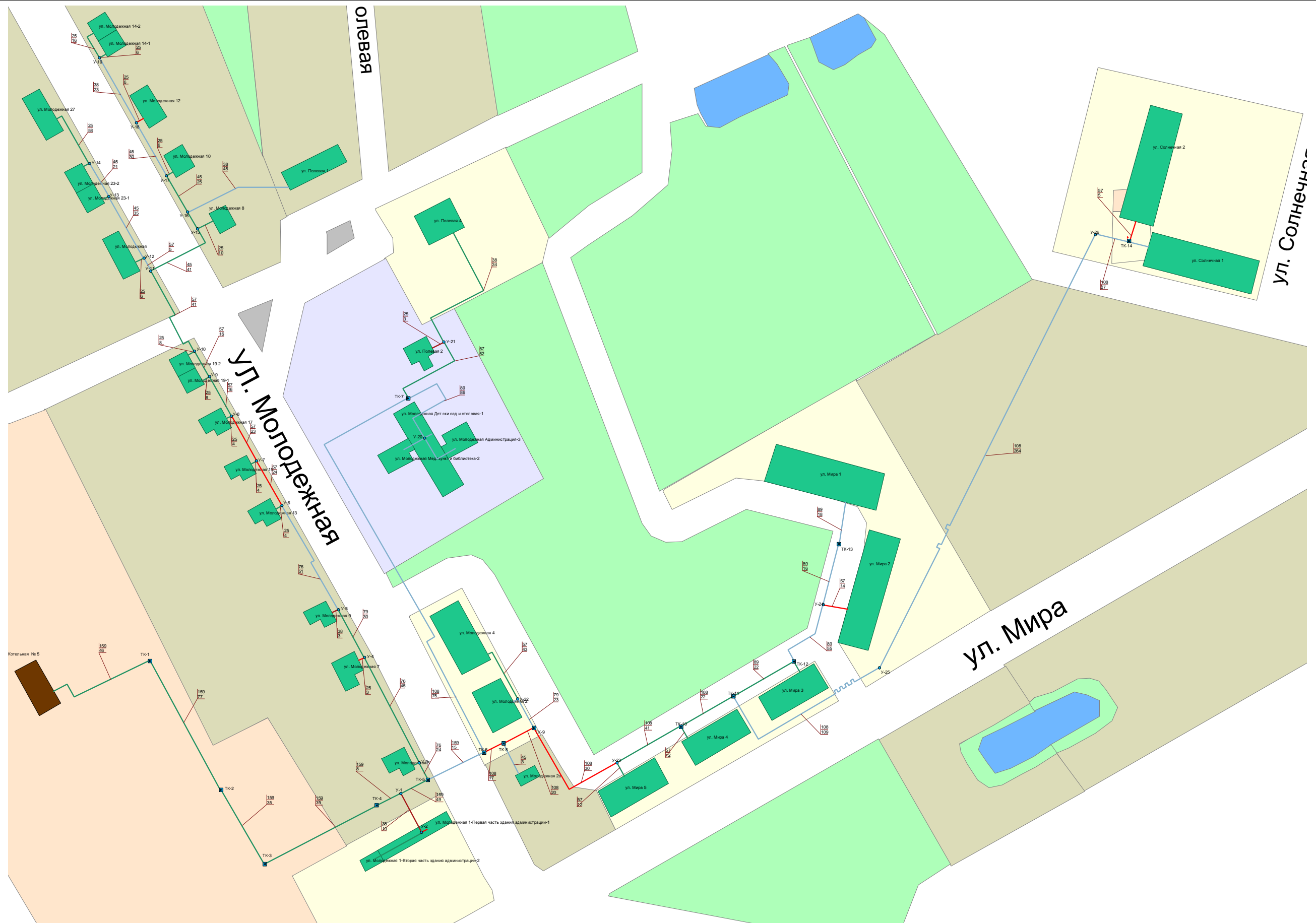
Рис. 5 Котельная д. Борисовское - наладочный режим системы теплоснабжения
